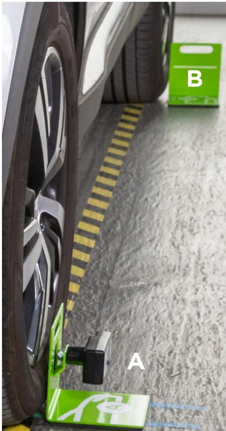
Die „Flex Set“-Module auf der linken Fahrzeugseite möglichst nah an die Räder positionieren (siehe Abbildung).
