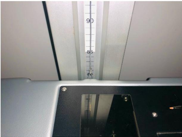
Die der Höhe entsprechende Wertespanne auswählen und durch Drücken von
