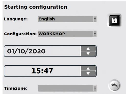
Una volta immessi i parametri, il REGLOSCOPE™ PRO chiederà di essere riavviato per applicare i parametri scelti.
