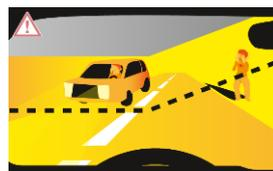
Ajuste demasiado alto con riesgo de deslumbramiento
