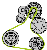
Tok energie zpět do řemenového pohonu motoru
